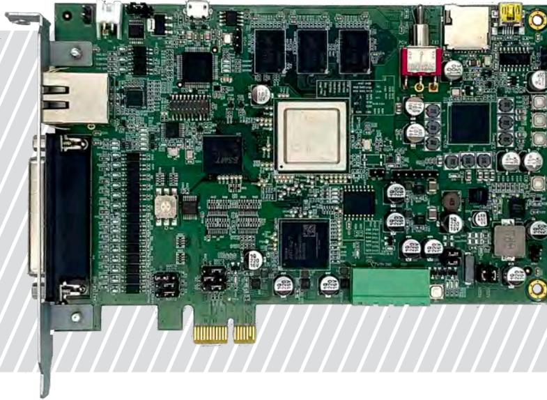
MCT-8164E 系列為 PCI Express 插槽的 EtherCAT Mater 控制卡，採用高速的 EtherCAT 網路系統可以即時對從端 (slave) 控制或狀態監測，實現自動化設備的即時控制需求，特別適用於半導體電子設備或其他高速設備的應用。MCT-8164E 系列能夠同時支持最多達 64 個同步軸，具有專用隔離緊急停止輸入 (EMG) 和可配置的隔離高速數位輸出輸入點，內建編碼器回授輸入具備位置比較觸發，位置栓鎖功能。提供豐富的運動控制動態函式庫，範例程式碼，診斷測試工具軟體，以及專用建置 EtherCAT 系統環境檔，以減少程式開發的負擔，幫助使用者輕鬆完成設置和診斷。
